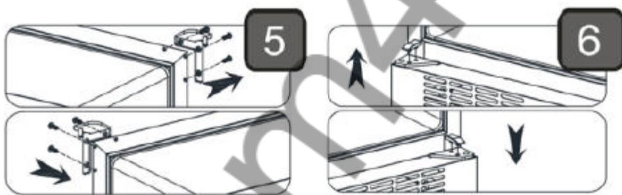
Перемістіть петлю та шайбу на протилежний бік. Знову встановіть дверцята та шурупи.
